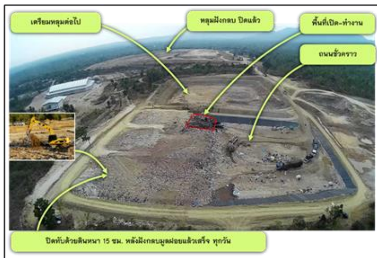
ที่มา: เอกสารนำเสนอการจัดการมูลฝอยจากอดีตถึงปัจจุบันและแผนอนาคต ของศูนย์กำจัดขยะมูลฝอยแบบผสมผสานบ้านตาล โดยนายประยุทธ ถนอมบุญ รูปที่ 3-47 ภาพรวมของการฝังกลบมูลฝอยตามหลักสุขาภิบาล
