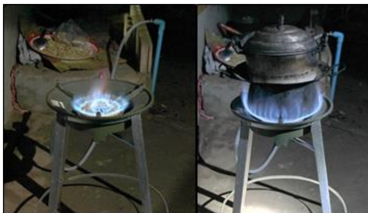
ที่มา: เอกสารนำเสนอการจัดการมูลฝอยจากอดีตถึงปัจจุบันและแผนอนาคต ของศูนย์กำจัดขยะมูลฝอยแบบผสมผสานบ้านตาล โดยนายประยุทธ์ ถานอมบุญ รูปที่ 3-50 การใช้ก๊าซชีวภาพจากหลุมฝังกลบมูลฝอยสำหรับใช้หุงต้มในครัวเรือน
