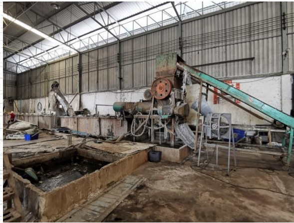
รูปที่ 3.4 กระบวนการล้างถุงพลาสติกที่ใช้แล้วและเป่าให้แห้ง
